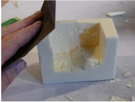
Gute Ergebnisse erzielt man mit 100er Schleifpapier
